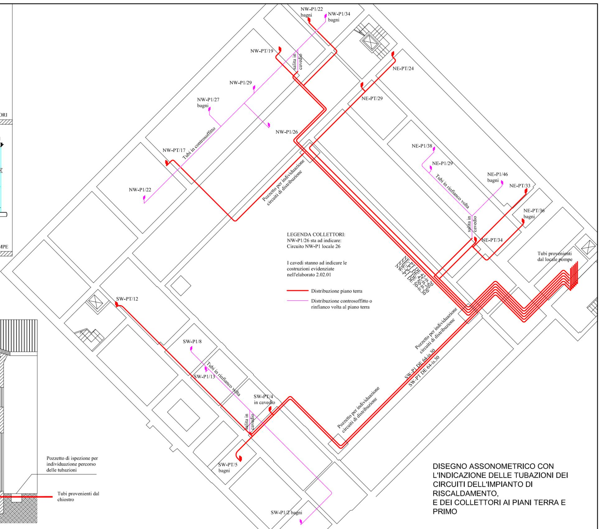
**DISEGNO ASSONOMETRICO CON L'INDICAZIONE DELLE TUBAZIONI DEI CIRCUITI DELL'IMPIANTO DI RISCALDAMENTO, E DEI COLLETTORI AI PIANI TERRA E PRIMO**
