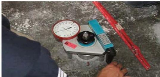
RISULTATI DELLE PROVE A STRAPPO PER LA VERIFICA DI ADESIONE AL SUPPORTO
