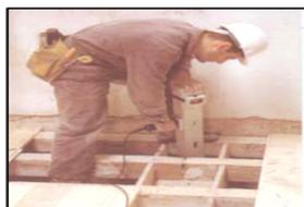
Esecuzione di prova resistografica (da op.cit. Gennaro Tampone, 2002).
