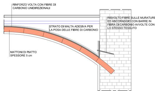
FASI DELL'APPLICAZIONE DEL RINFORZO CON FIBRE DI CARBONIO:
