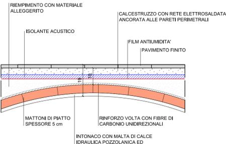
SEZIONE TIPO VOLTA
