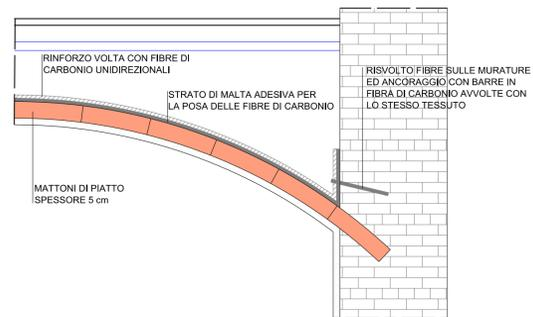
PARTICOLARE ANCORAGGIO RINFORZI VOLTA ALLA MURATURA PERIMETRALE
