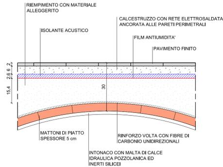
SEZIONE TIPO VOLTA - SCALA 1:10
